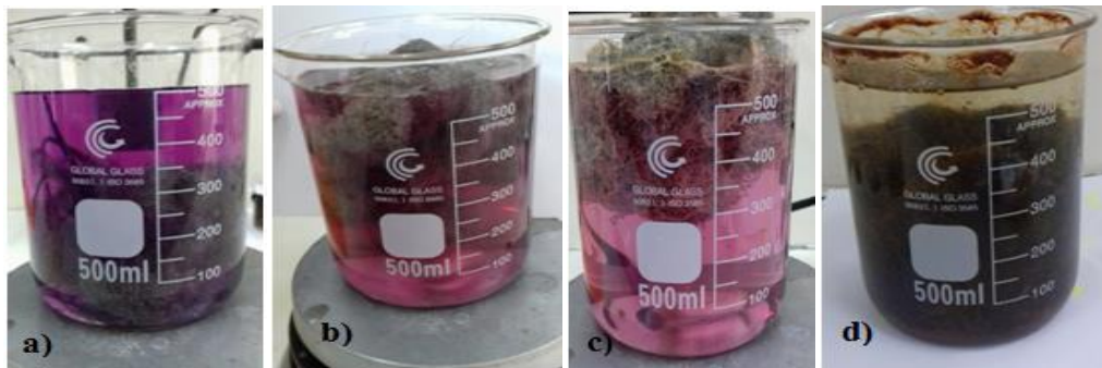
Figura 3 - (a) solução contendo corante têxtil violeta e lã de aço; (b) adição de peróxido de hidrogênio na solução; (c) a solução de corante após a agitação magnética; (d) solução de corante têxtil violeta degradada.
