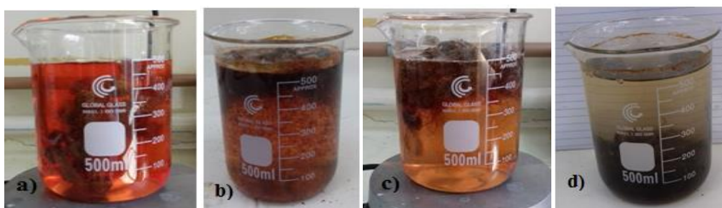
Figura 1 - (a) solução contendo corante têxtil vermelho e lã de aço; (b) adição de peróxido de hidrogênio na solução; (c) a solução de corante após a agitação magnética; (d) solução de corante têxtil vermelho degradada.
